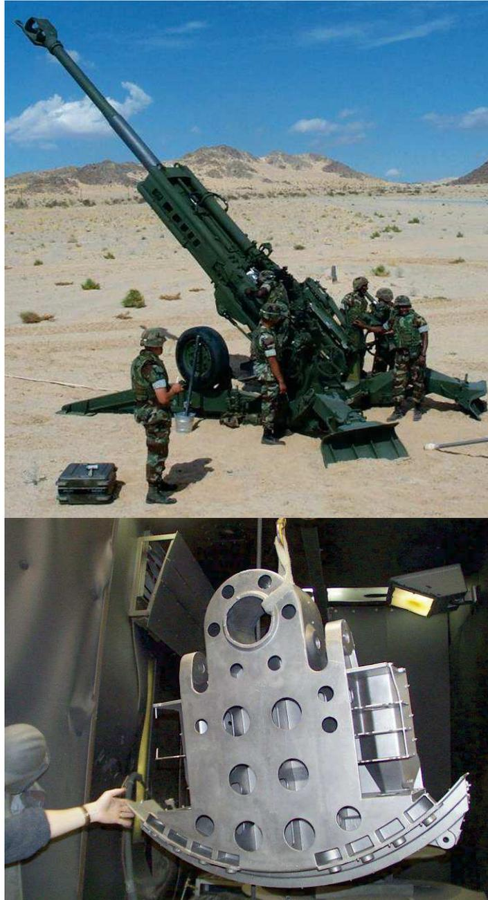
**Figure 69: Châssis en titane du canon d'artillerie Howitzer de 155mm [réf.23]**
