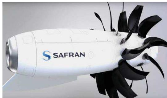
**Figure 26: Concept de soufflante non carénée (source : Safran)**
