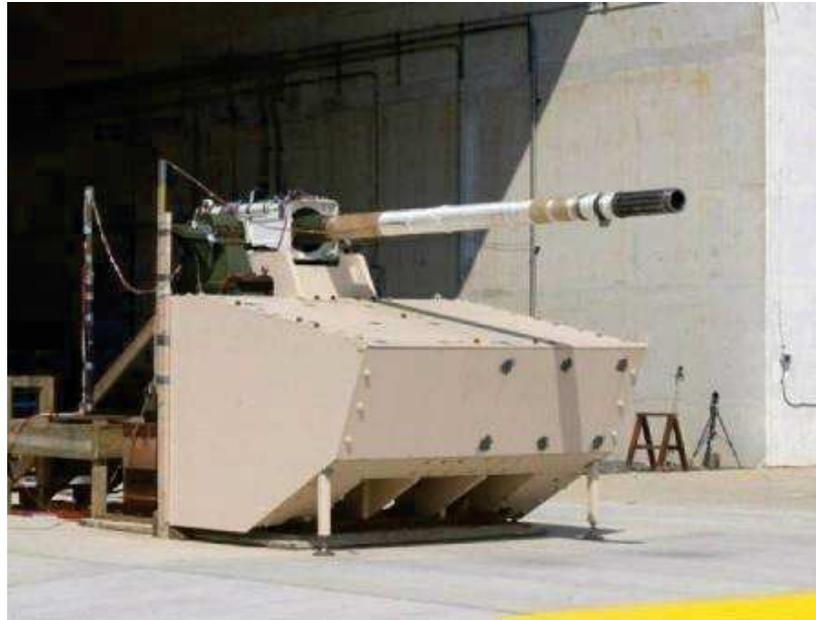
**Figure 70: Projet de châssis en titane du “Futur Combat System” (US Army)**
