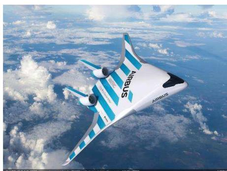
Figure 24: Démonstrateur d'aile volante MAVERIC de type BWB (source : Airbus)
