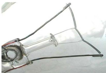
Ampoule à filament de tungstène
