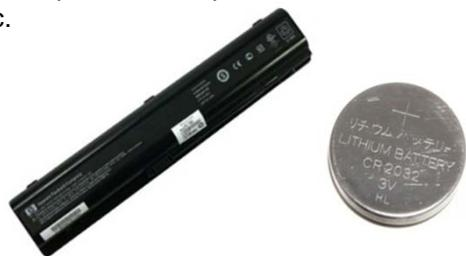
Batterie rechargeable au lithium pour ordinateur portable et pile bouton non rechargeable au lithium
