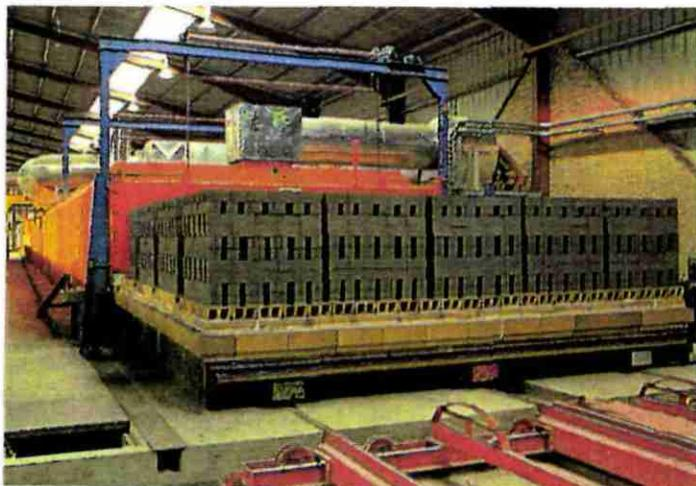
Ph. 1 - Après séchage dans un séchoir à chambres, entrée des produits secs dans le four-tunnel Ceric. Briqueterie de Saint-Palais (18). Huguenot-Fenal.
