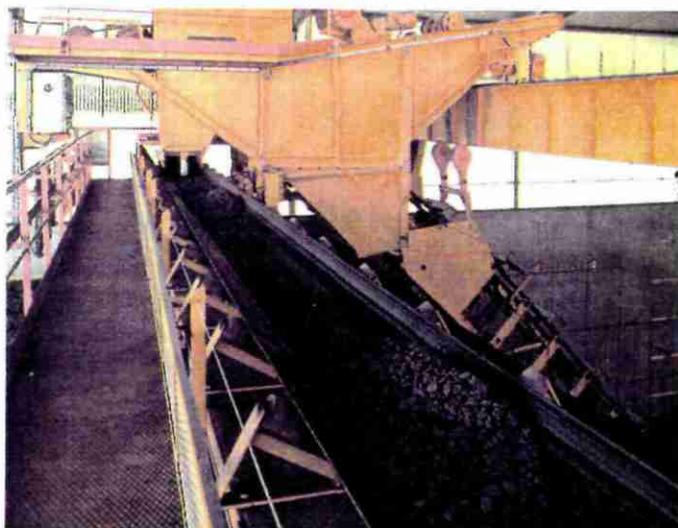
Ph. 3 - Reprise des terres en fosse et transport par bande à la chaîne de fabrication. Tuileries de Pottelberg, usine d'Aalbeke (Belgique).
