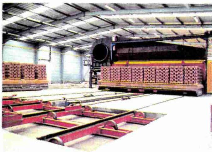
Ph. 2 - Sortie d'un wagon de briques cuites du séchoir-four Casing Ceric de la briqueterie d'Hulluch (62).
