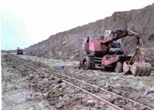
Ph. 3 - Exploitation de l'argile à la pelle hydraulique. Carrière de Templeuve (59). Briqueteries du Nord.
