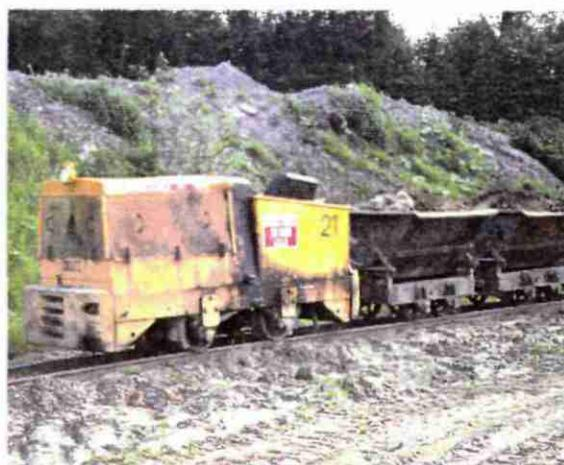
Ph. 4 - Transport de l'argile à l'usine par wagonnets et locotracteurs. Carrière de Templeuve (59). Briqueteries du Nord.
