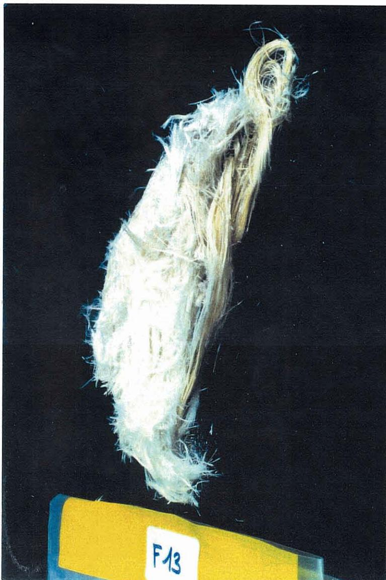
*Fig. 7 - Fibres d'amiante (1° plan) sur fibres organiques.*
