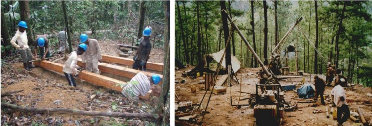
Figure 13. Gauche : Préparation d'une plateforme de sondage, six employés locaux en phase d'acquisition de nouvelles compétences (Cliché : Newmont). Droite : Foreuses carottées légères en action avec un déboisement minimal lors du projet Sysmin Restauración en République Dominicaine (Cliché : P.Urien, BRGM).
