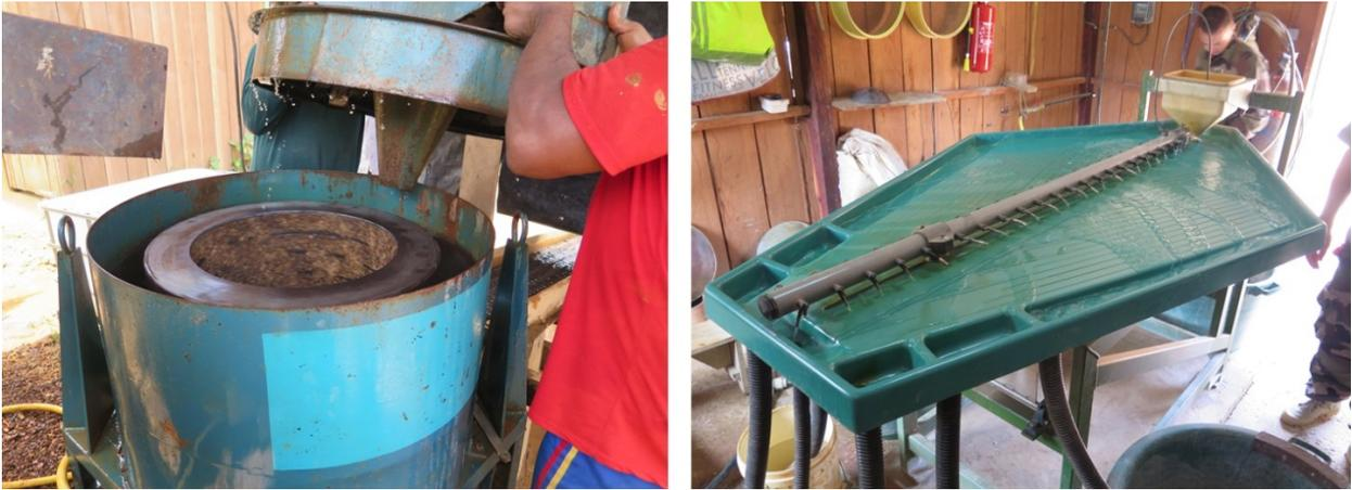
Figure 17. Gauche : Concentrateur centrifuge. Droite : Table à secousses (Source : J.-F. Thomassin).
