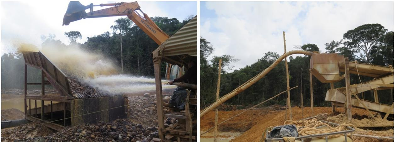
Figure 16. Gauche : Débourage sur grille avec sluice simple au-dessous. Droite : Alimentation de la pulpe vers le sluice ayant une boîte à gravier en tête. Sluice en 3 sections en Z (Source : J.-F. Thomassin).
