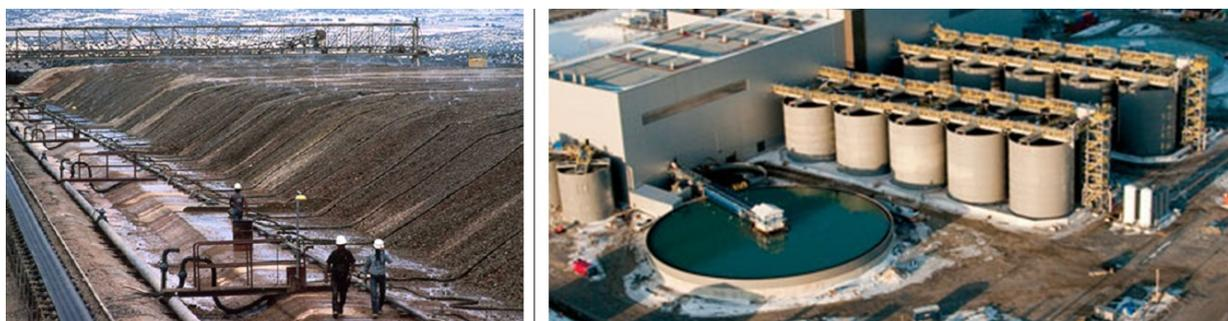
Figure 22. Gauche : Lixiviation en tas avec arrosage par le dessus et récupération des solutions par le bas sur les liners. Droite : Cuves de cyanuration et adsorption sur charbon actif.
