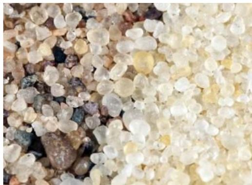
Figure 28 - Type de sable utilisé pour la fracturation hydraulique (source [www.onyxpg.com](http://www.onyxpg.com)).
