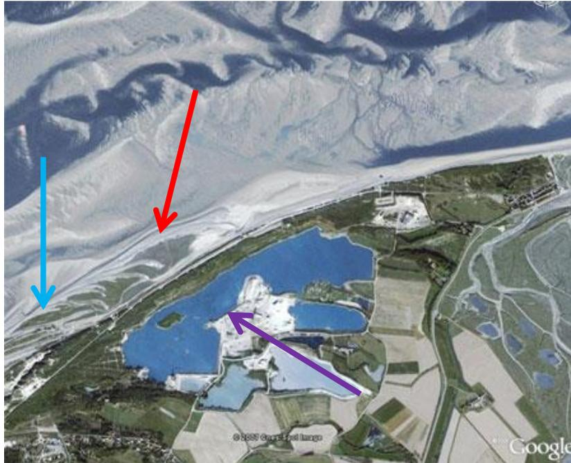
Figure 16 - Vue aérienne du site du Hourdel sur la commune de Cayeux-sur-Mer (source Google Earth, 2016) où sont exploités les galets de silex, à terre et sur l'estran, avec rechargement du tonnage extrait sur l'estran (en rouge) par un tonnage équivalent (en bleu).
