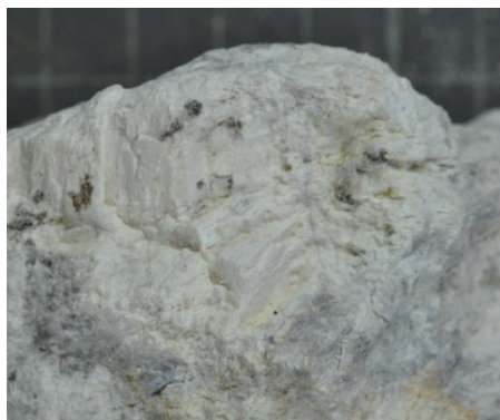
Figure 28 - Lépidolite (paillettes mauves, photo de gauche) et pétalite (masse blanc-crème, photo de droite) de Chèdeville.
