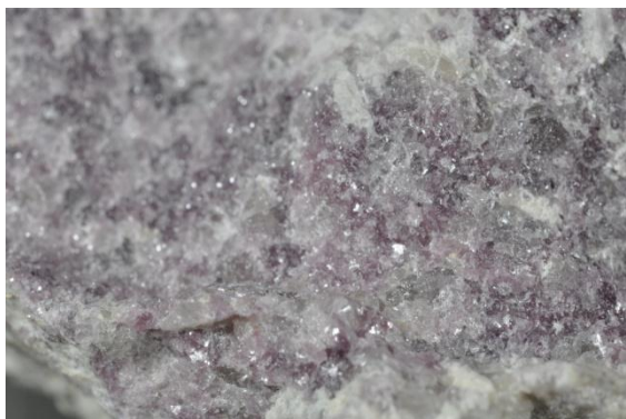
Figure 28 - Lépidolite (paillettes mauves, photo de gauche) et pétalite (masse blanc-crème, photo de droite) de Chèdeville.
