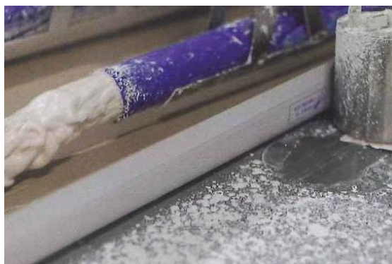
Injection de plâtre, après mélange avec d'autres constituants, sur le carton inférieur (ACP Presse)
