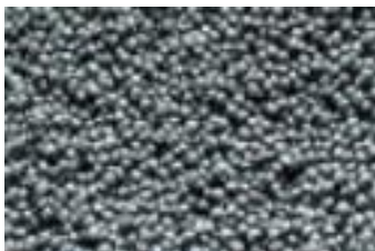
Billes céramiques pour proppants (© www.proppant.saint-gobain.com)
