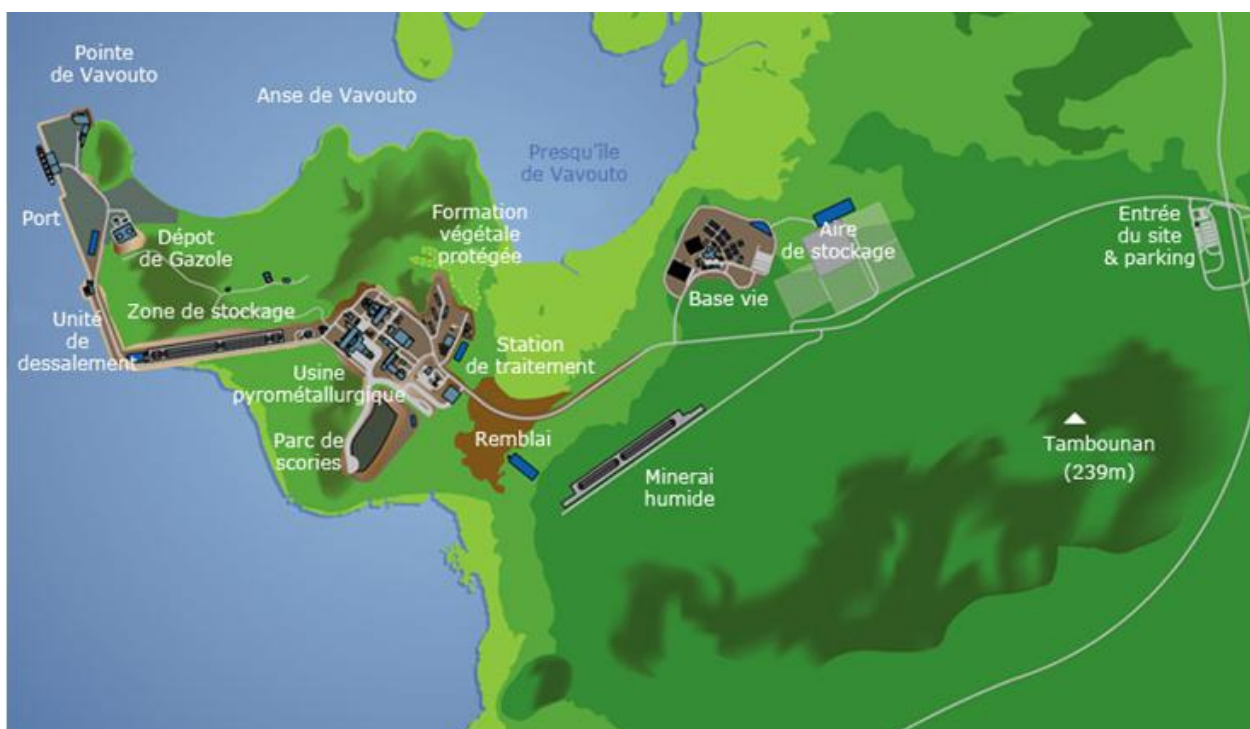
Plan des installations de Koniambo Nickel sur le site industriel de Vavouto ( Koniambo Nickel ).
