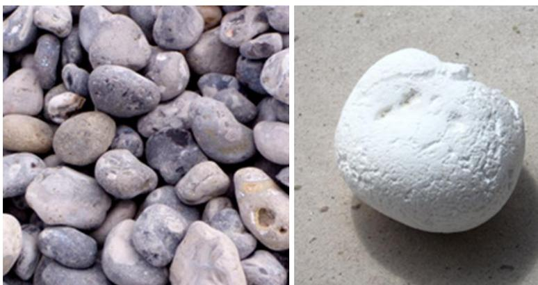
Figure 14 : Galets de silex roulés du littoral et cristobalite obtenue par calcination (à droite)
