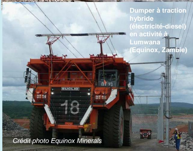
Dumper à traction hybride (électricité-diesel) en activité à Lumwana (Equinox, Zambie)
