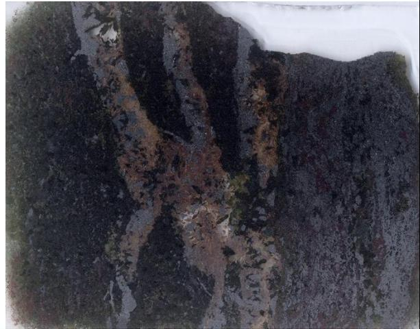
*Photo 4 : Échantillon de skarn à cassitérite (brune), magnetite (gris) et amphibole (vert sombre) de Tellerhäuser - (Breitenbrunn, Saxe, Allemagne)*
