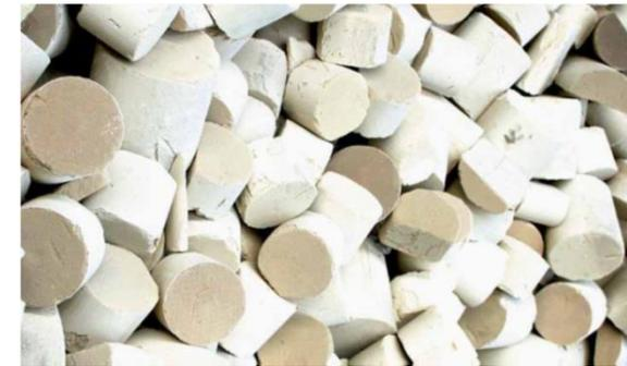
Monolithes de catalyseurs imprégnés de platinoïdes, usagés, pour recyclage
