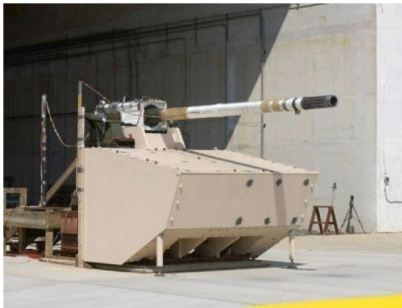
**Figure 72: Projet de châssis en titane du “Futur Combat System” (US Army)**
