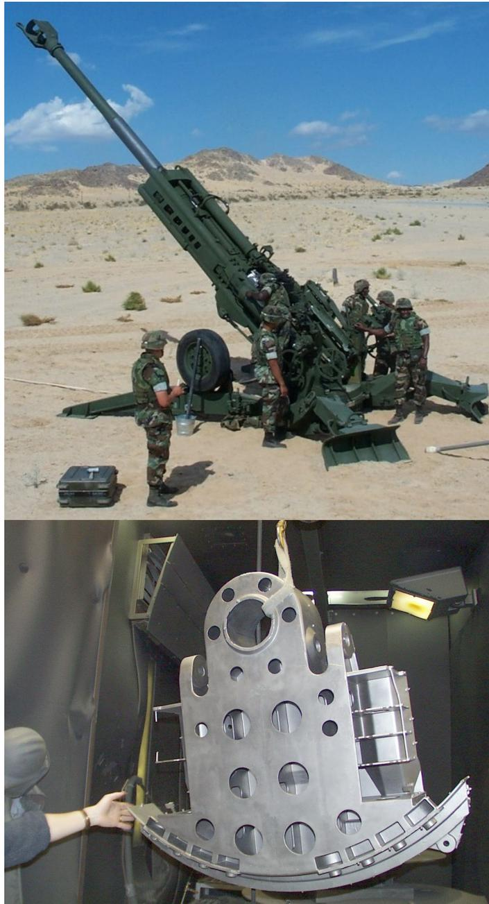
**Figure 71: Châssis en titane du canon d'artillerie Howitzer de 155mm [réf.24]**
