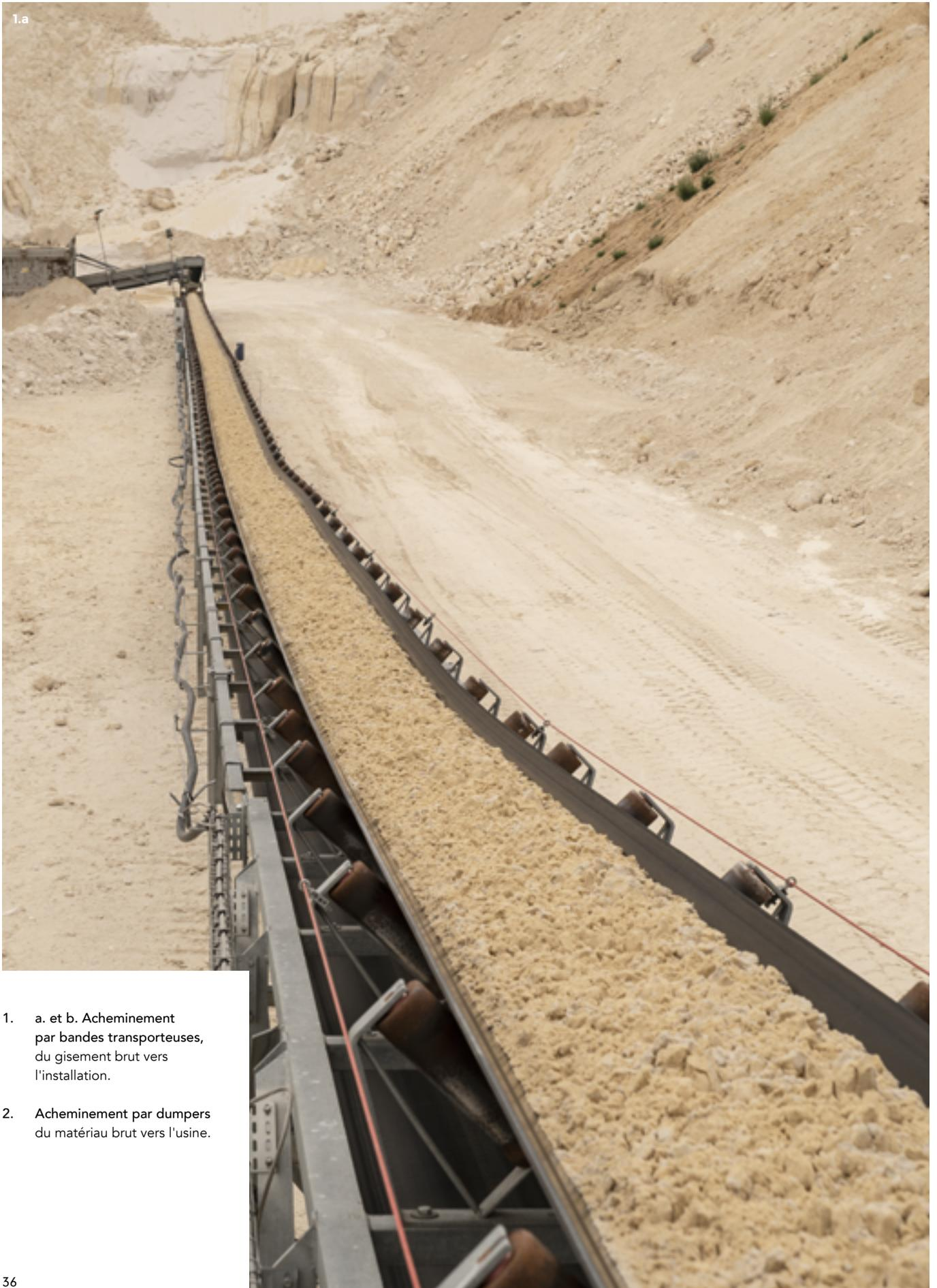
1. a. et b. Acheminement par bandes transporteuses, du gisement brut vers l'installation.
