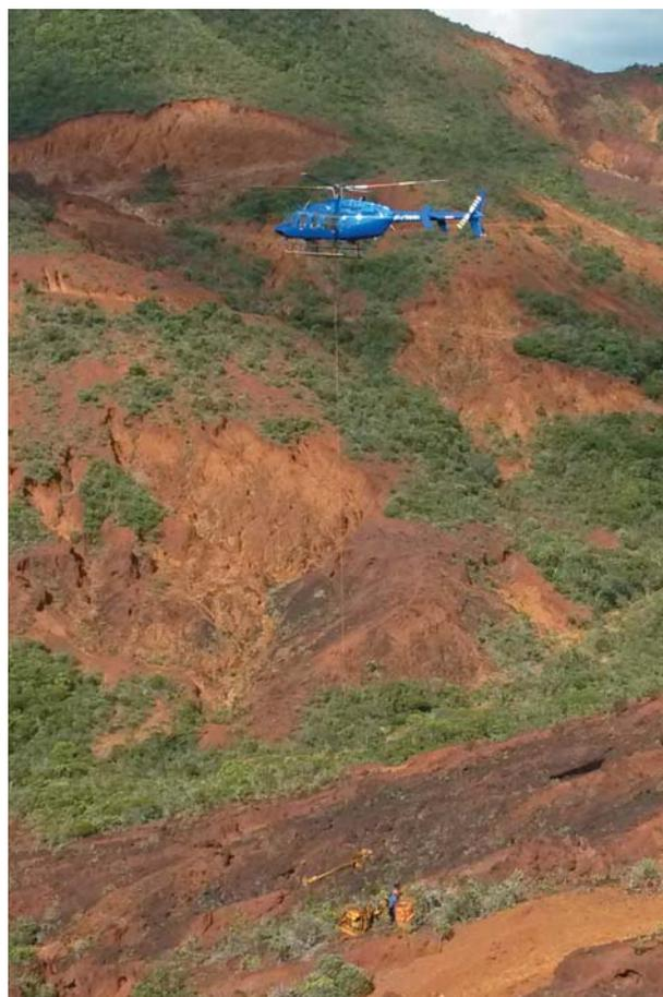
Photo 1. Hélicoptage d'une sondeuse en région Grand Sud (source : DIMENC).
