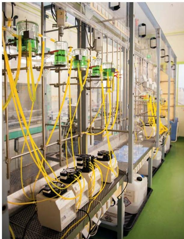
Photo 1. Installation d'extraction liquide-liquide au CIM (source : Areva, avril 2015).
