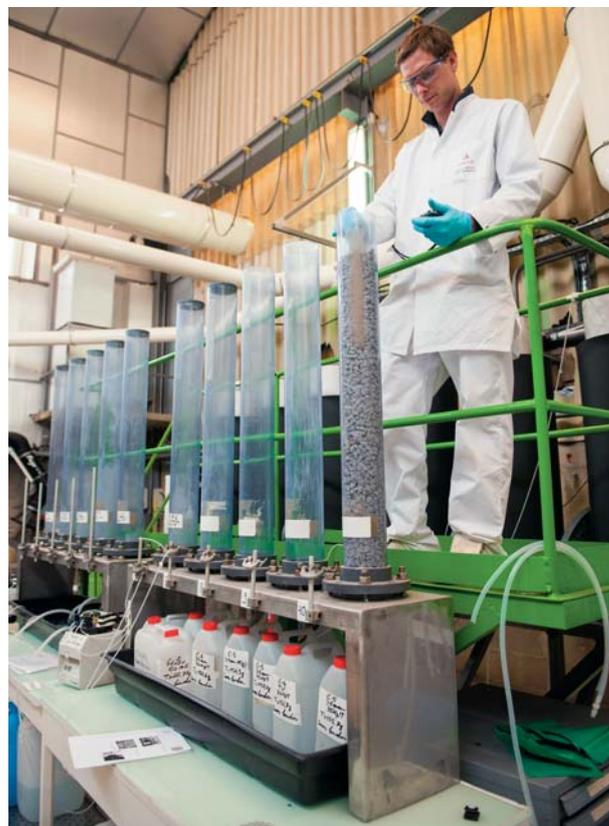
Photo 2. Test de lixiviation en colonne (source : Areva, avril 2015).
