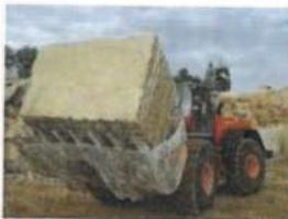
La manutention des blocs de pierres qui peuvent atteindre 40 tonnes se fait généralement par des chariots élévateurs, grues, chargeurs, ou derrick.
