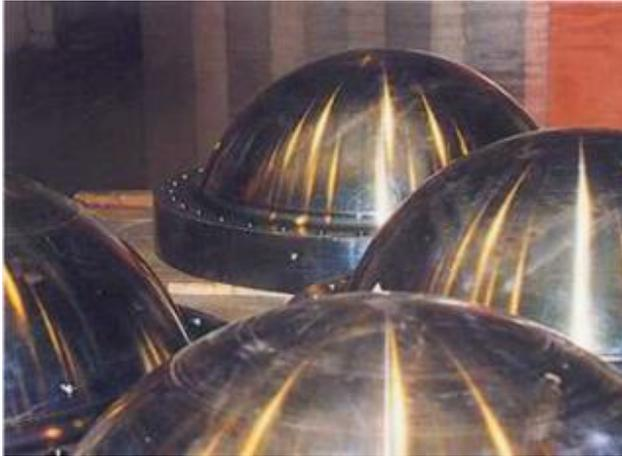
Coquille de condenseur et de réfrigérant
