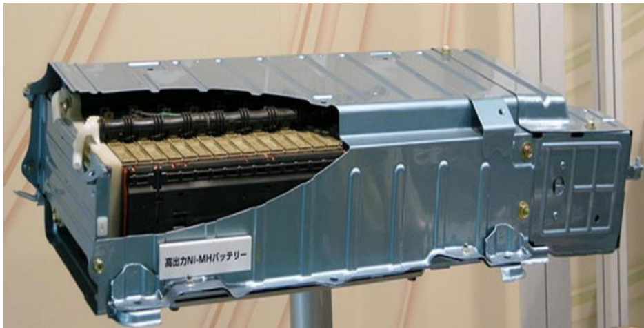
Figure 15 - Batterie NiMH utilisée dans les véhicules hybrides (contient 10 à 15 kg de Terres Rares, lanthane principalement) (source : Lucas, 2014).
