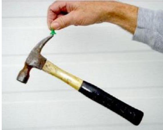
Figure 8 - Illustration de la taille et de la force d'aimantation d'un aimant permanent Nd-Fe-B (© J.Lucas).
