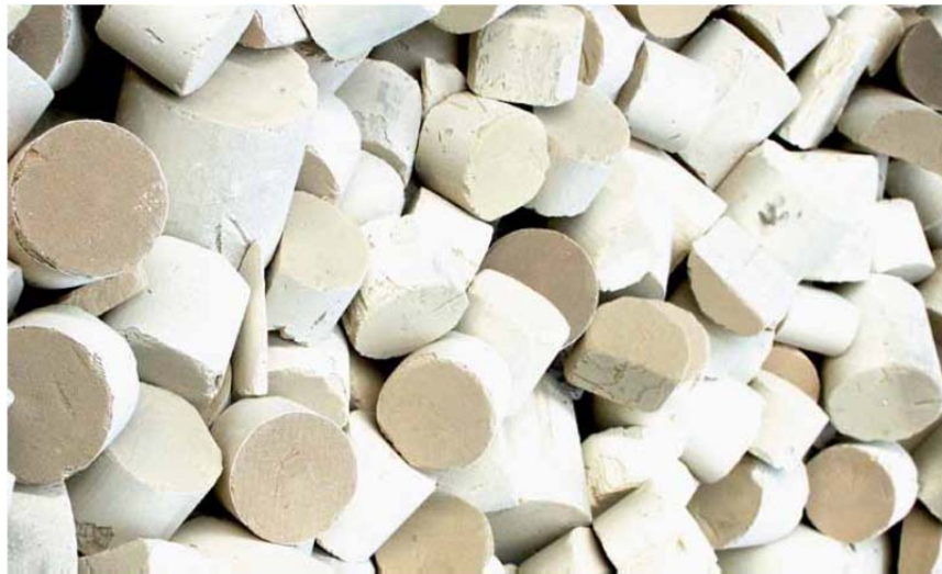
Figure 77 - Monolithes usagés de catalyseurs automobiles, imprégnés de platinoïdes, pour recyclage (© Umicore, Rapport Annuel 2012).
