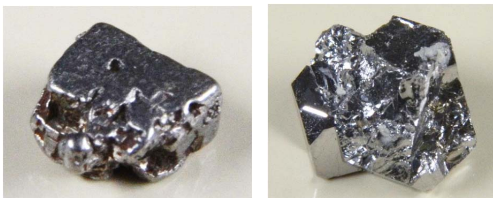
Figure 51 - À gauche, cristal cubique de platine natif (Konder/Kondyor, Khabarovsk, Russie). À droite : cristal de sperrylite (Talnakh, Norilsk district, Russie) (photos JF. Labbé).
