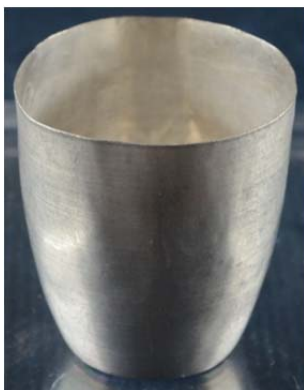
Figure 19 - Creuset de laboratoire en platine (Laboratoire du BRGM).
