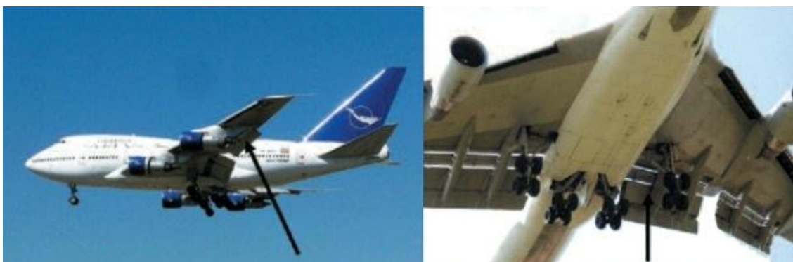
Figure 6 : Volets et ailerons (flèches) d'avions dont le système de contrepoids est en alliage lourd de tungstène (© www.itia.com ).
